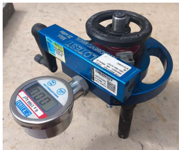
Figura 5 – Aderímetro para ensaio de arrancamento
