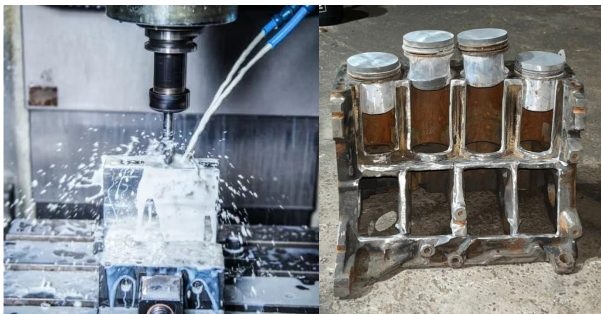
Figura 07: Bloco durante e após o corte longitudinal
