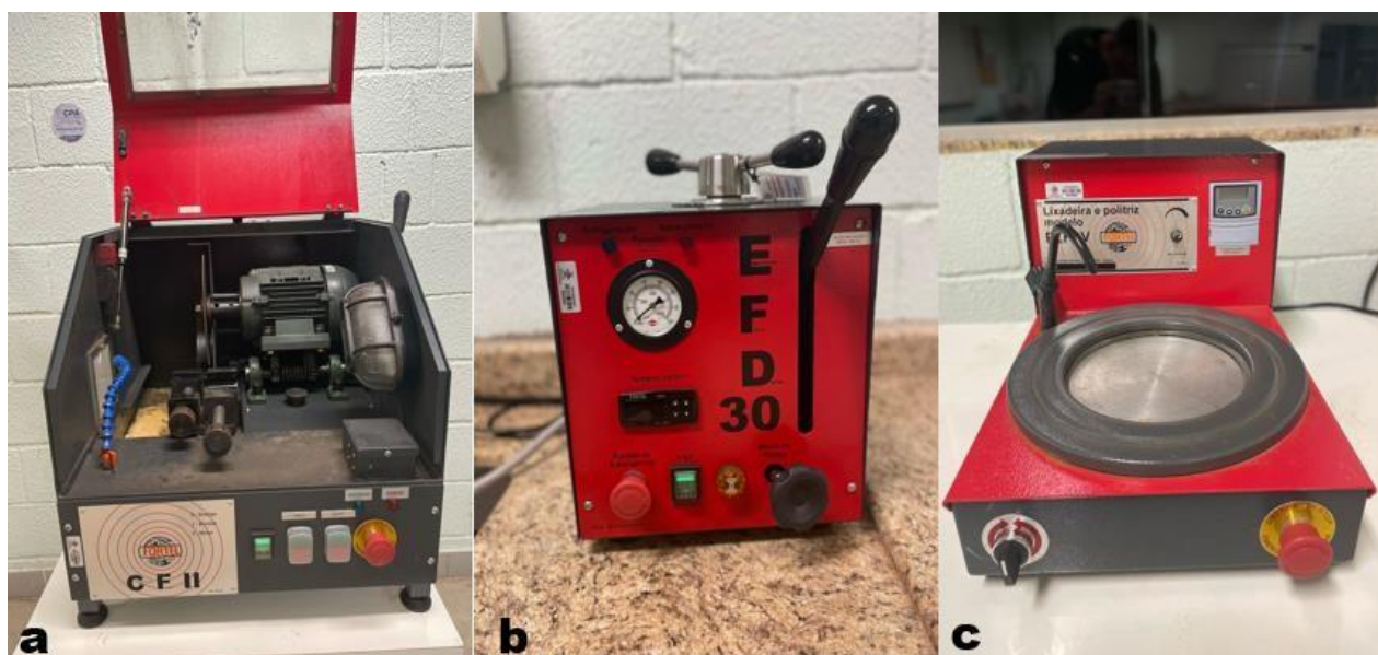
Figura 06: Equipamentos utilizados na preparação das amostras: a) Cortadora metalográfica, b) Embutidora e c) Lixadeira Politriz
