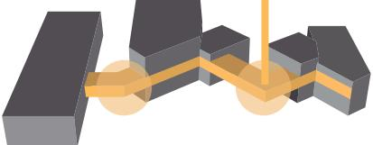
Pilares em "V" de estrutura metálica revestidos de alumínio, resultando em faces desiguais.
