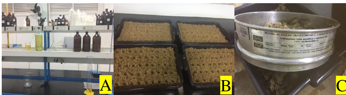
FIGURA 2: (A) Preparo das soluções de glifosato em laboratório; (B) Teste padrão de germinação com quatro repetição de 50 sementes; (C) Processo de esterilização da areia, lavada com água na peneira granulométrica de metal.
