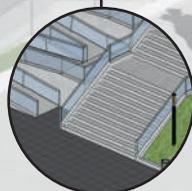
Escadas em concreto aparente. Corrimãos em aço galvanizado e vidro laminado de 6mm.
