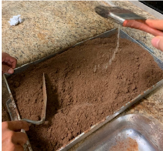
Figura 11 - Umidificação dos componentes
