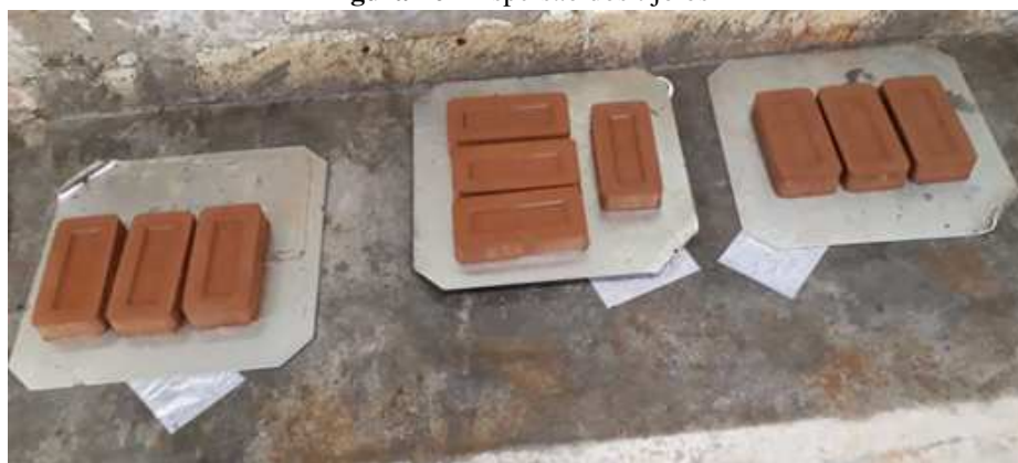
Figura 16 - Aspersão dos tijolos
