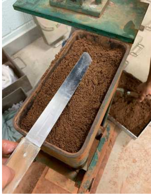
Figura 14 - Disposição do material no molde da prensa
