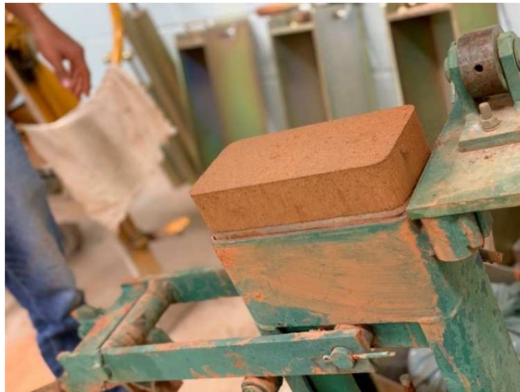
Figura 15 - Tijolo ecológico solo-cimento-escória
