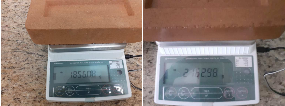
Figura 20 - Pesagem do tijolo seco e saturado
