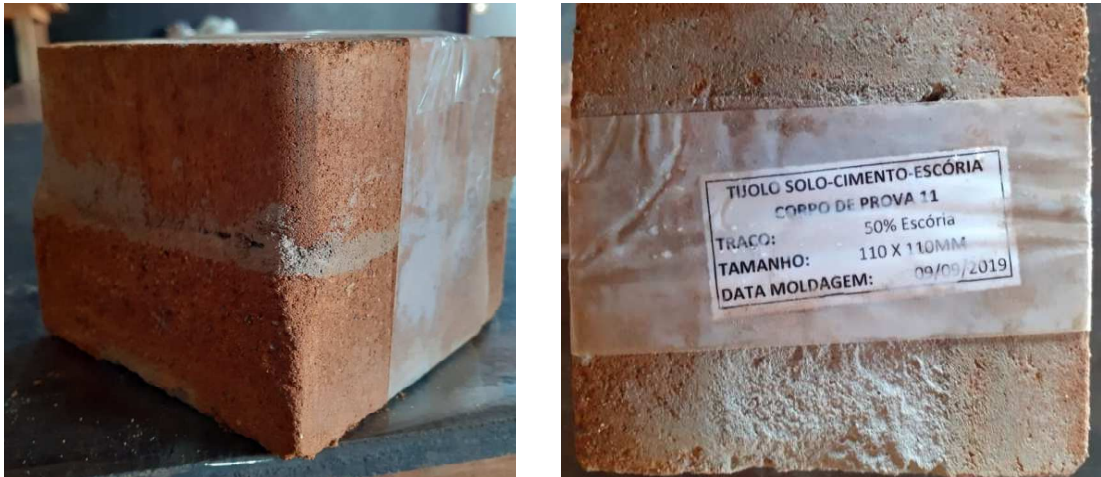
Figura 17 - Moldagem do corpo de prova e Etiquetagem do corpo de prova
