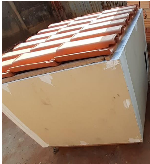
Figura 6 – Protótipo de drywall
