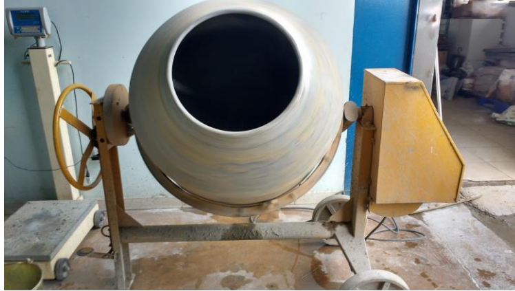
Figura 2 - Betoneira utilizada para mistura
