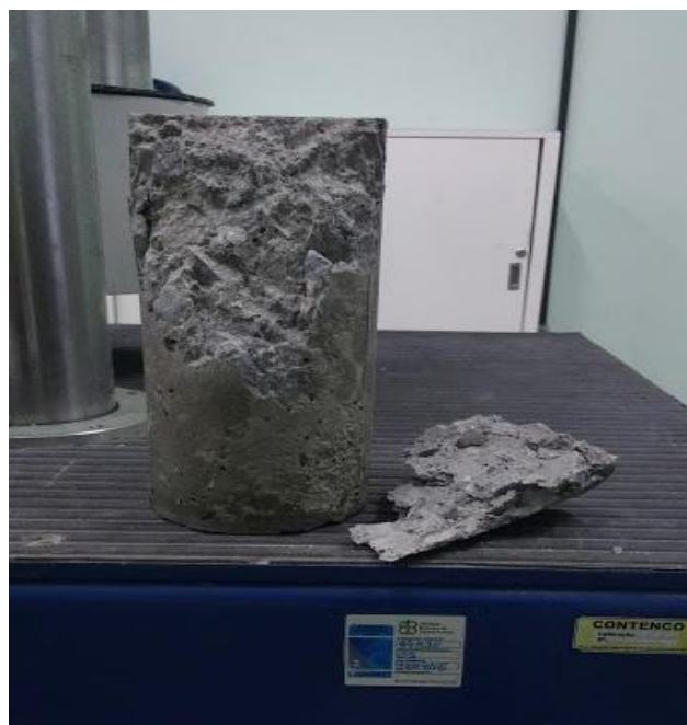
Figura 82 – Ruptura de um Corpo de prova aos 28 dias
