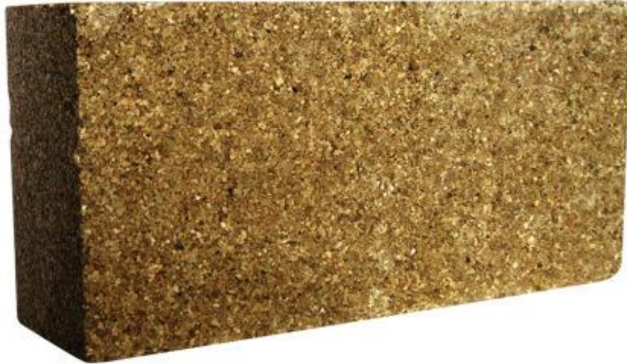
Figura 15 - Tijolo isolante de vermiculita expandida
