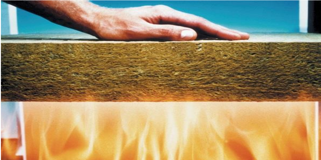
Figura 17 - Lã de rocha: resistência ao fogo acima de 200 graus Celsius
