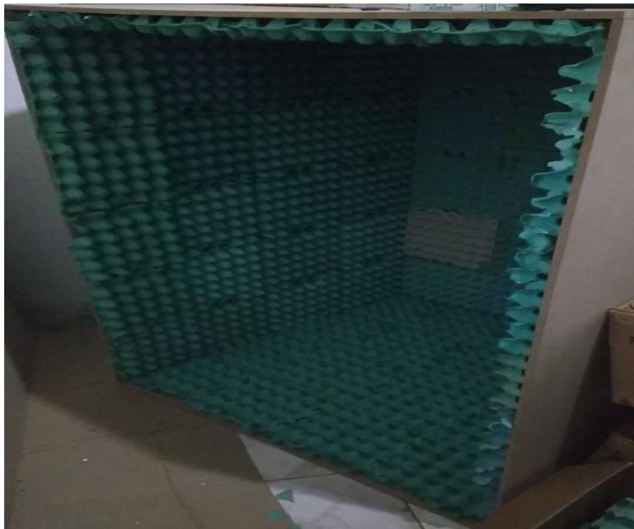
Figura 34 – Caixa acústica terminada
