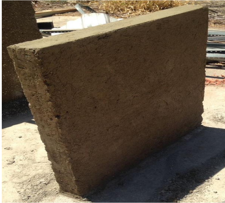
Figura 30 – Parede revestida com cortiça
