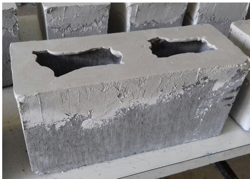
Figura 11 - Regularização do Bloco de Concreto
