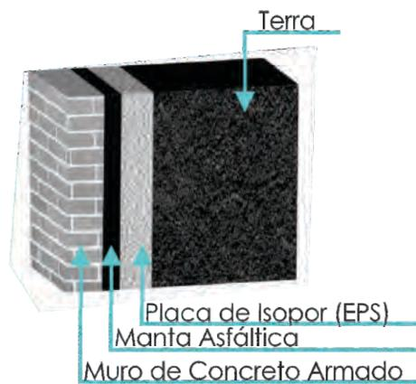
Para a drenagem do muro será utilizado placas de isopor e manta asfáltica, materiais estes que são eficazes no sistema de escoamento da água, diminuem o custo da obra, agilizam e simplificam a execução.
