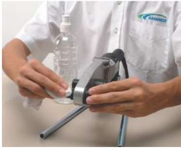
a) Limpeza do termofusor
