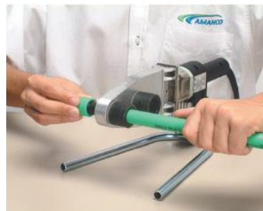
f) Aquecimento do termofusor
