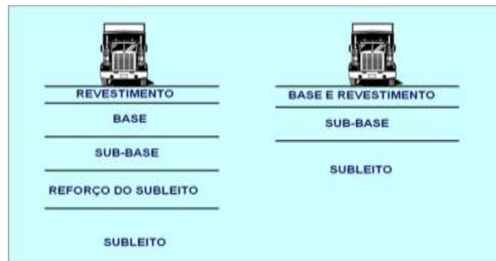
Figura 02 - Ilustração das camadas do pavimento
