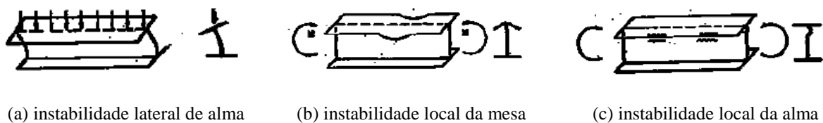
Figura 33- Instabilidade local das chapas componentes do perfil
