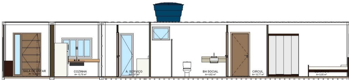
Figura 37 - Corte AA - Projeto Contêiner
