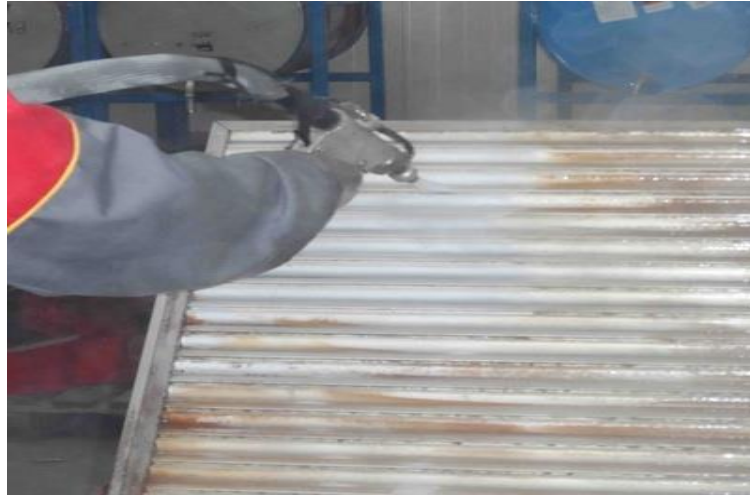
Figura 8 - Processo de jateamento
