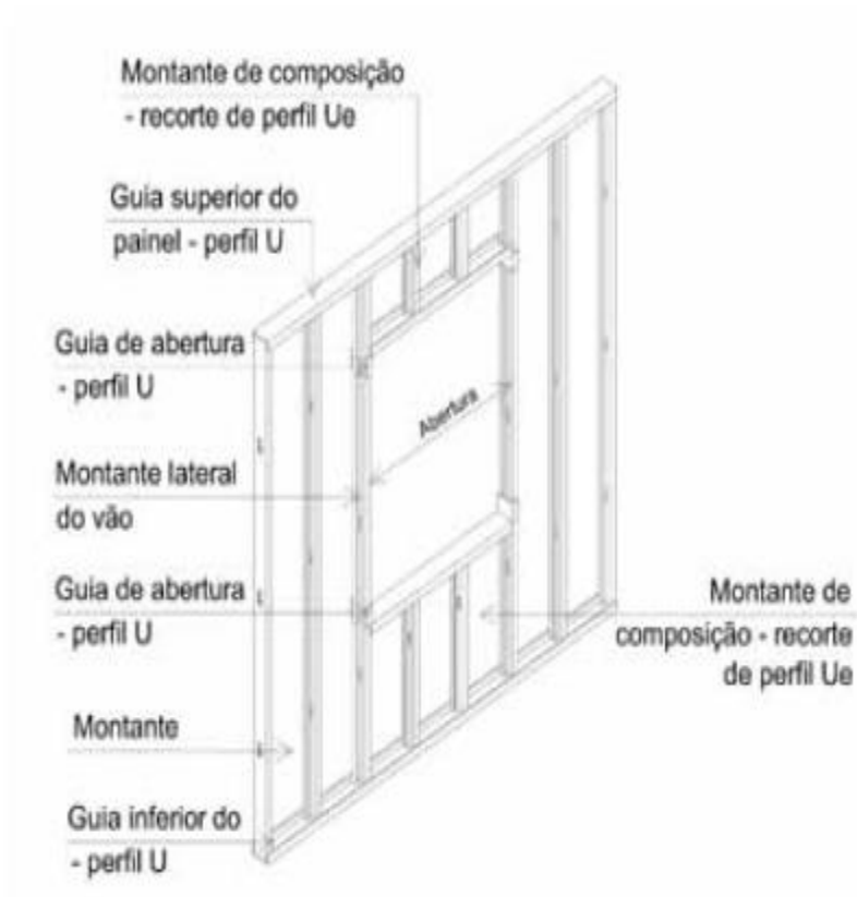
Figura 13: Esquema de painel não estrutural com abertura.
