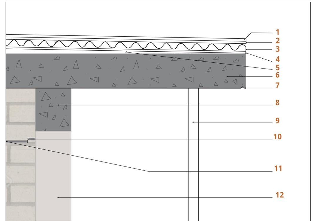
**Detalhe 2 - Impermeabilização da laje**
