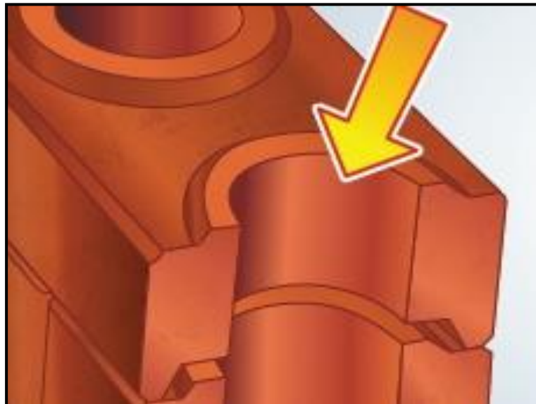
Figura 22 - Formação de câmaras termo acústicas
