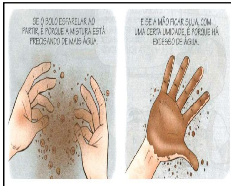
Figura 4 - Observação prática da umidade ideal do solo-cimento
