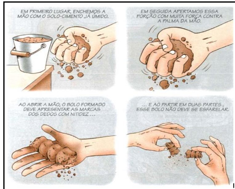
Figura 3 - Observação prática da umidade ideal do solo-cimento
