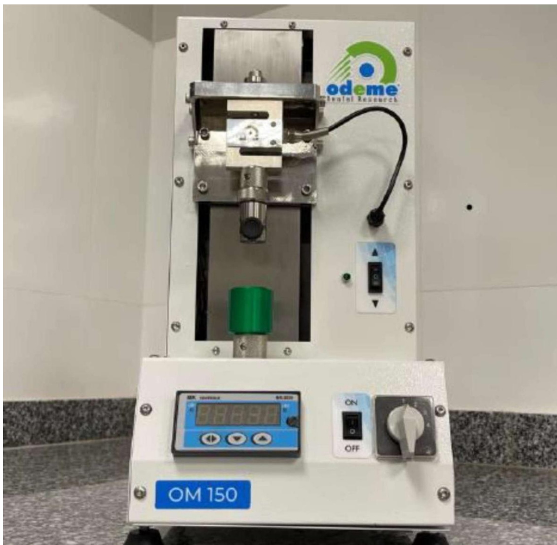
Figura 2. Máquina de ensaio universal Odeme OM 150, utilizada para realizar o teste de micromicropush-out.
