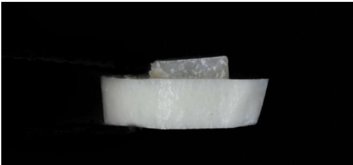
Figura 6. Configuração do material restaurador após sua extrusão do canal radicular da fatia.
