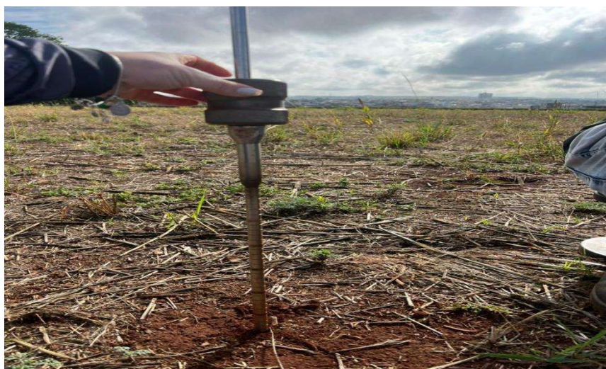
FIGURA 2 – Coleta de dados com penetrômetro de impacto na Fazenda Escola da UniEvangélica, na cidade de Anápolis - GO, 2025.
