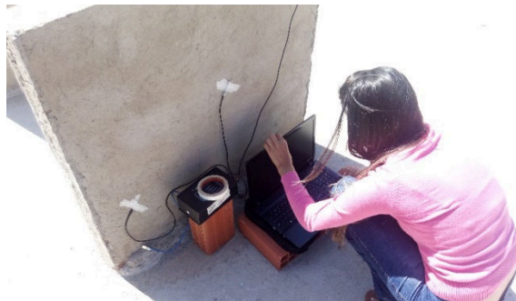
Figura 25 - Instalação do sensor Arduino no local da medição
