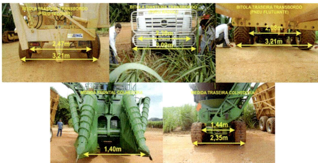
Figura 9 - Medidas do transbordo e colhedora Fonte: Dados da pesquisa adaptado pelo autor 2013.
