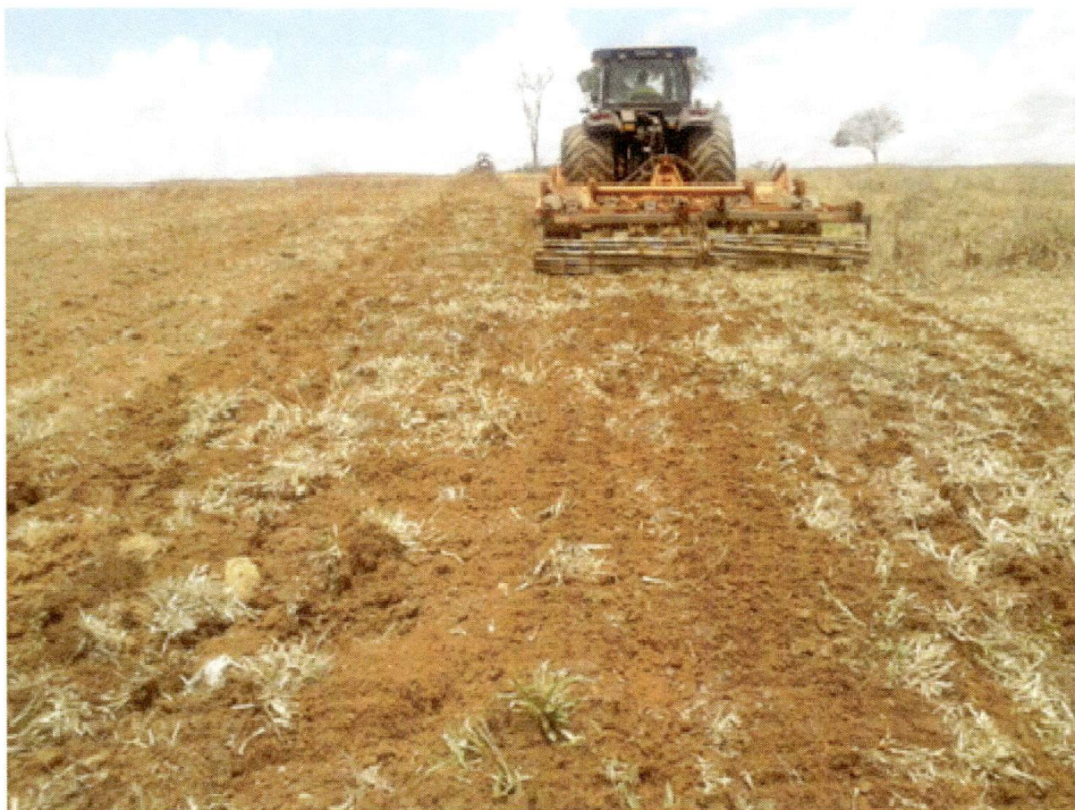
Figura 17 - Trator Valtra BH 205i subsolando a Fazenda Muralha com Subsolador ASDACR de 07 Hastes
