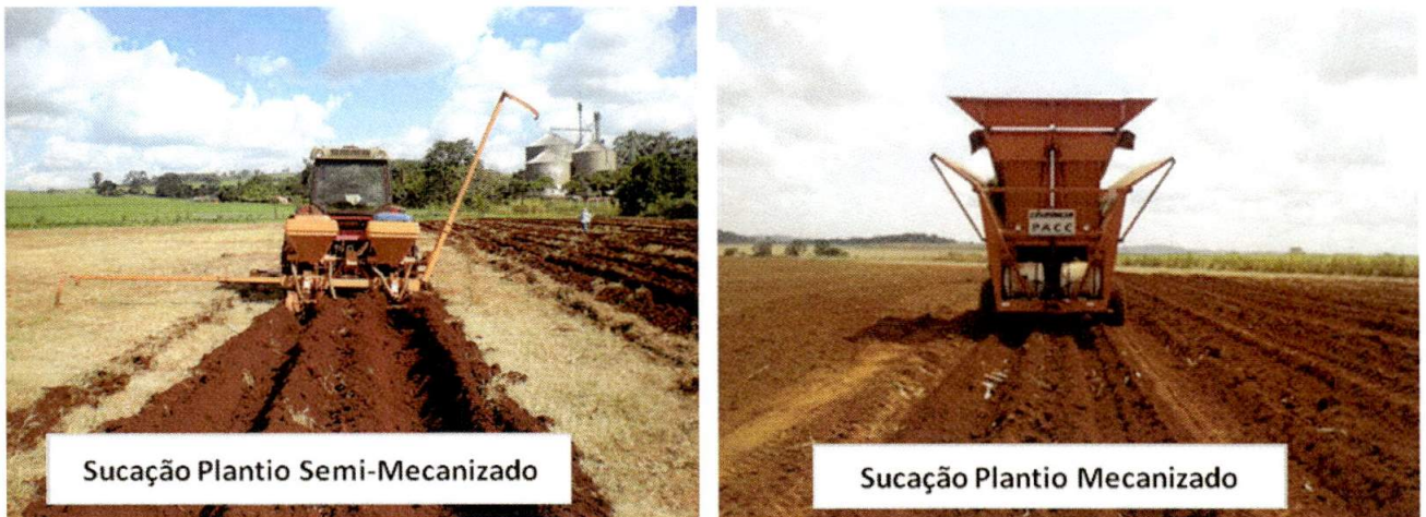
Figura 20 - Sucação para plantio semimecanizado (A), e plantio mecanizado na (B) observação na B, todo o ciclo já sai pronto enquanto na A, apenas a sucção e a aplicação do adubo Fonte: Dados da pesquisa adaptado pelo autor 2013.
