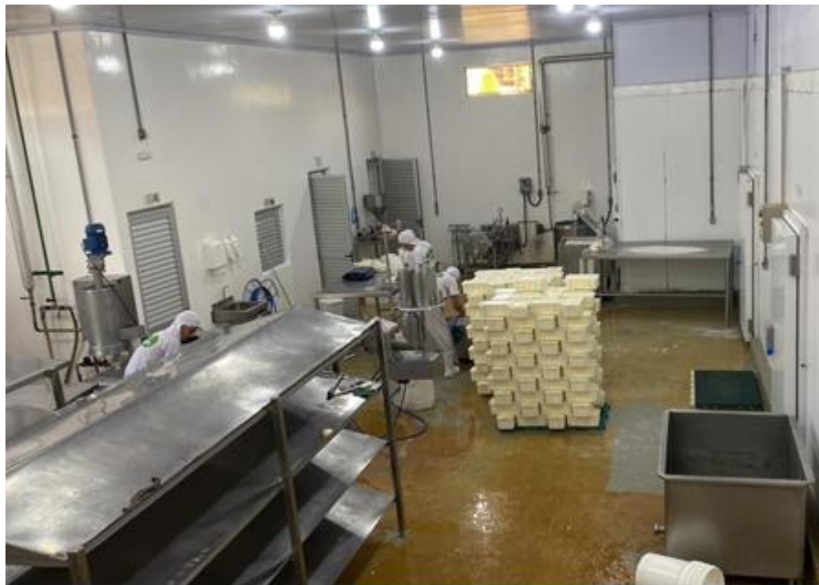
Figura 3 - Risco de acidentes: piso escorregadio (molhado).
