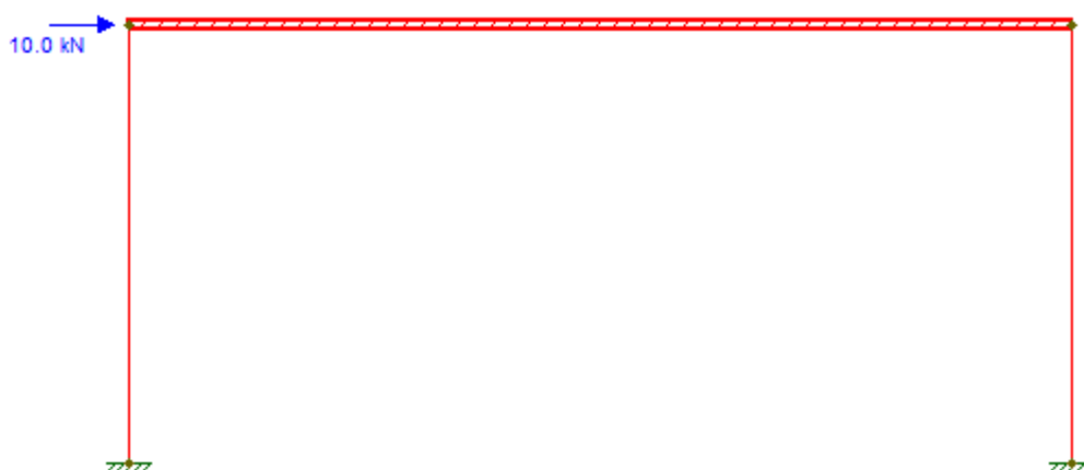
Figura 64 – Força horizontal aplicada ao pórtico
