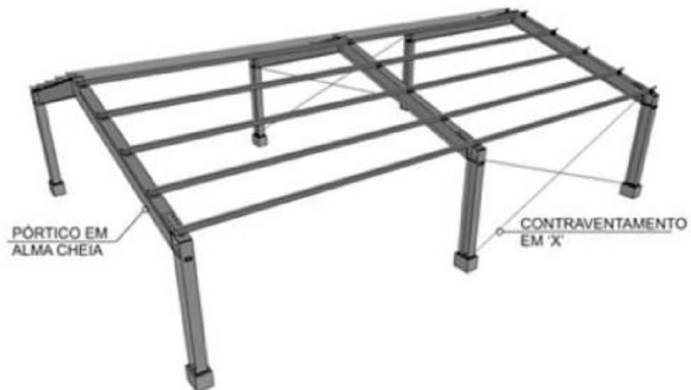
Figura 23 – Esquematização de pórtico simples de alma cheia
