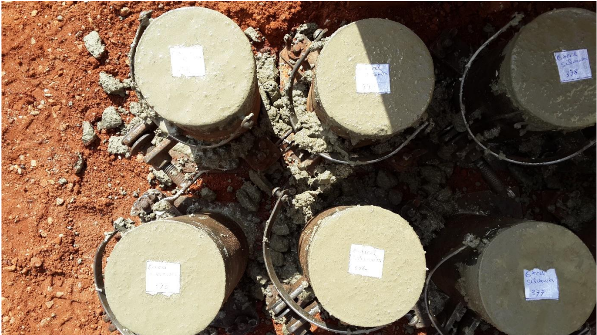
Figura 8 – Corpos de prova para análise da resistência do concreto
