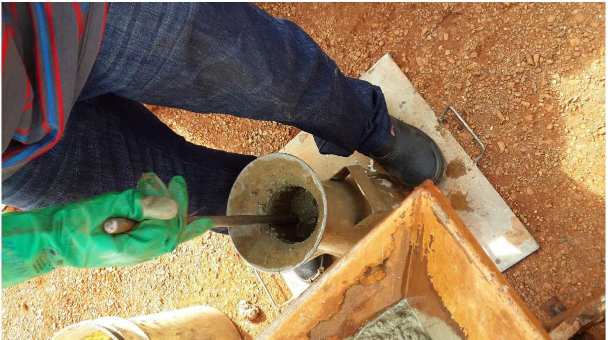
Figura 7 – Execução do procedimento para verificação do abatimento (slump) concreto
