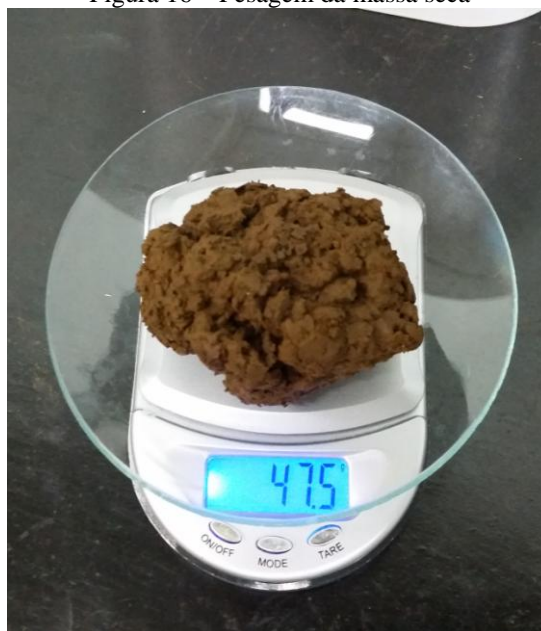
Figura 16 – Pesagem da massa seca
