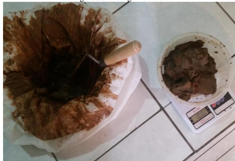
Figura 36 – Pesagem do lodo
