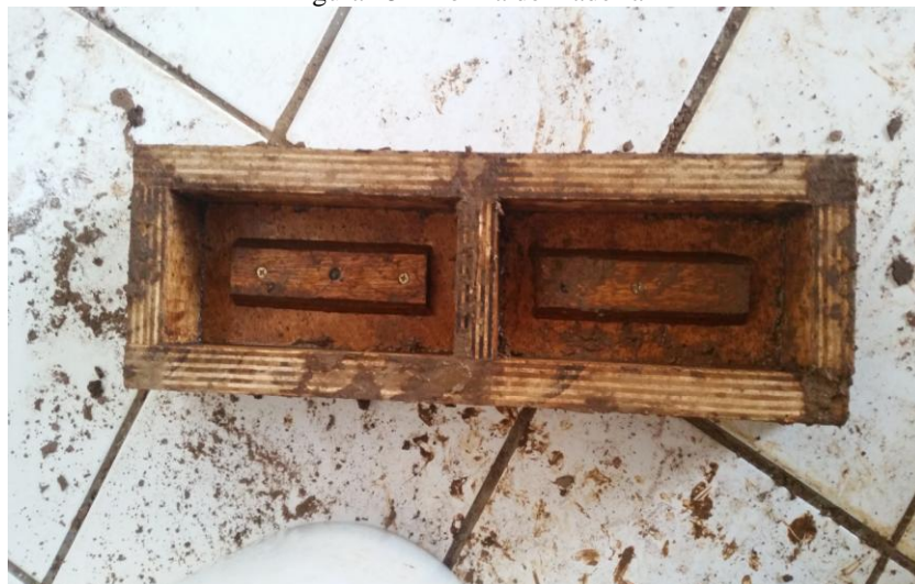
Figura 25 – Fôrma de madeira
