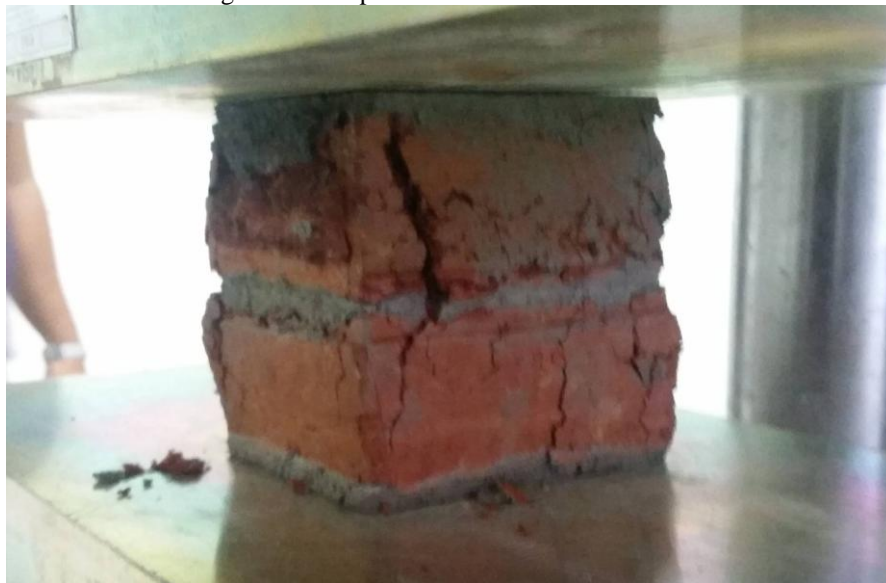
Figura 43 – Ruptura do Bloco – fissura vertical
