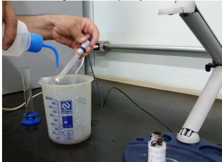
Figura 20 – Calibração do pH-metro
