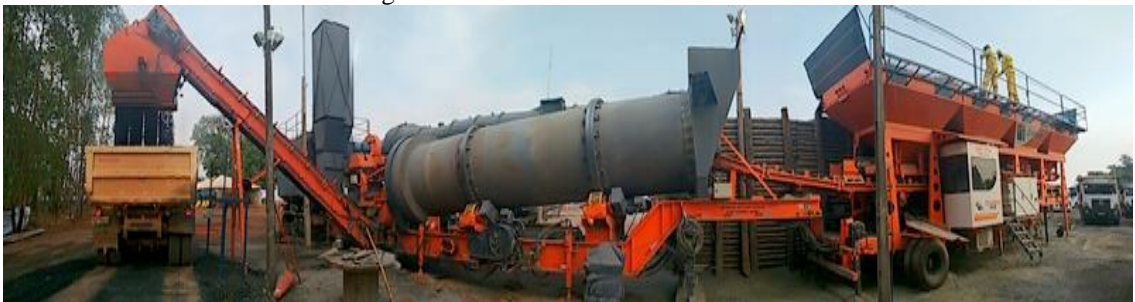
Figura 6 - Usina de concreto asfáltica.
