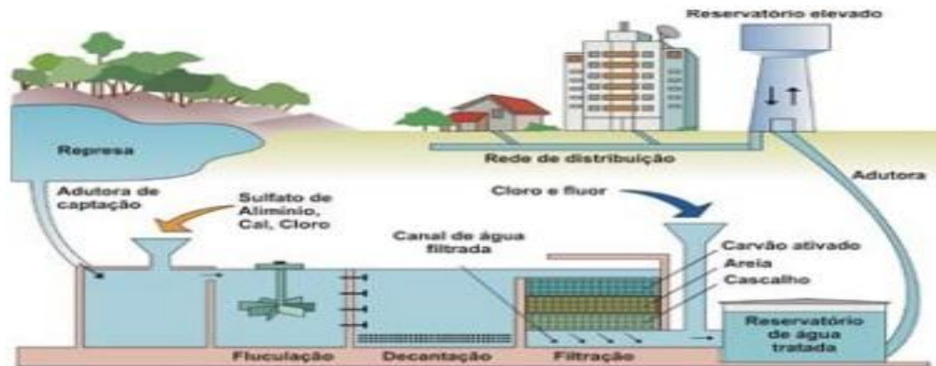
Figura 2 - Esquema de tratamento de água.
