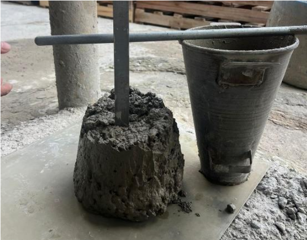
Figura 6: Teste slump concreto sem aditivo superplastificante
