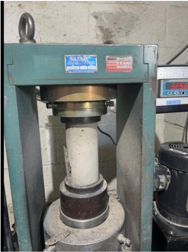
Figura 4: Rompimento aos 28 dias sem aditivo superplastificante
