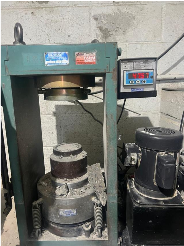
Figura 5: Rompimento aos 28 dias com aditivo superplastificante
