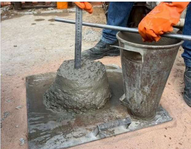
Figura 7: Teste slump concreto com aditivo superplastificante
