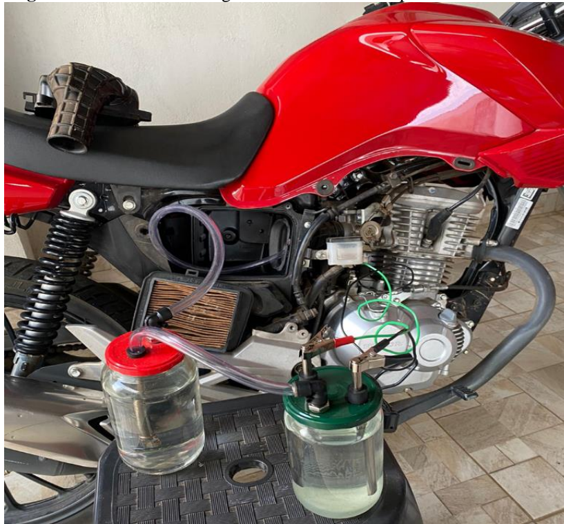
Figura 9 – Gerador de hidrogênio e borbulhador acoplado ao veículo teste.
