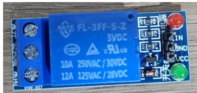
Figura 6 –Módulo relé 5V 1 canal.
