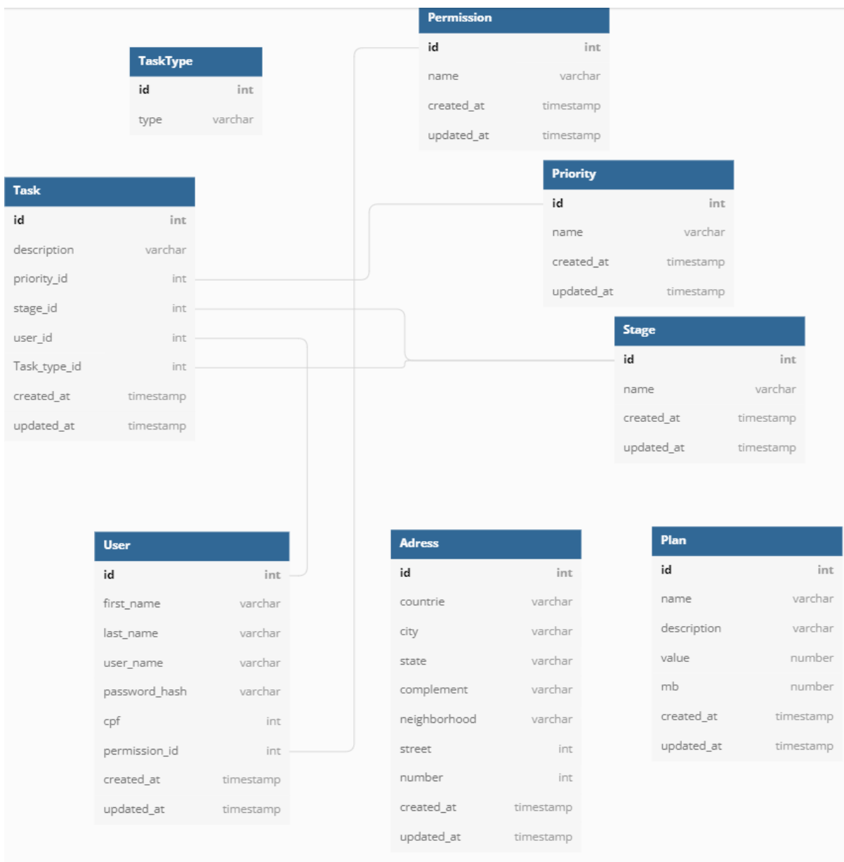
Figura 5 - Diagrama de classe principal da aplicação web.
