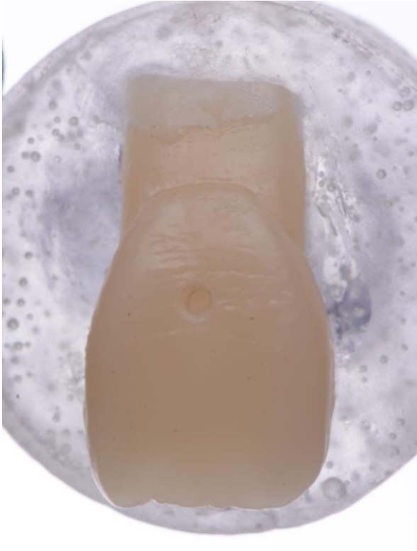
Figura 5: Nicho para assentamento da ponta aplicadora de força da máquina de ensaio universal.
