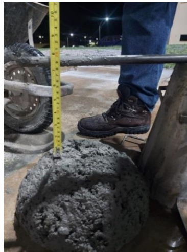
Figura 13 – Slump test concreto referencia
