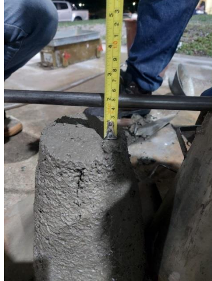
Figura 15 – Slump test com 10% substituição
