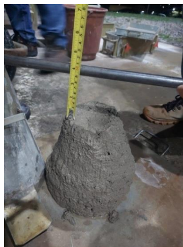
Figura 14 – Slump test substituição 5%
