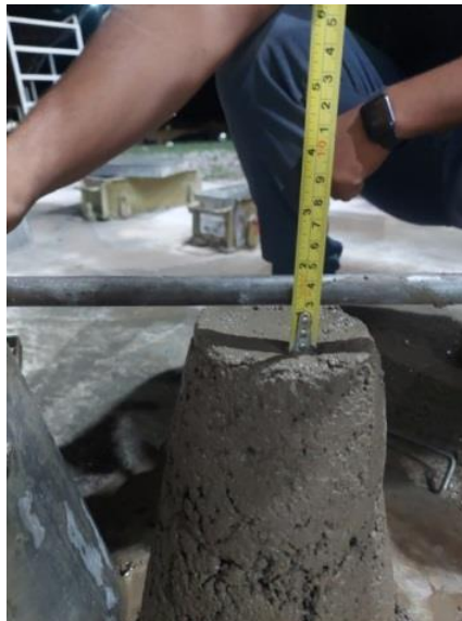
Figura 16 – Slump test com 20% substituição
