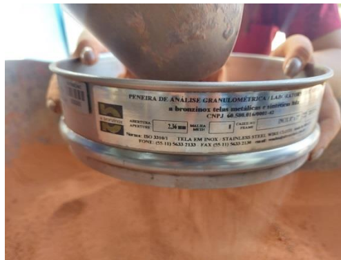
Figura 10 – Peneiramento do Agregado miúdo artificial
