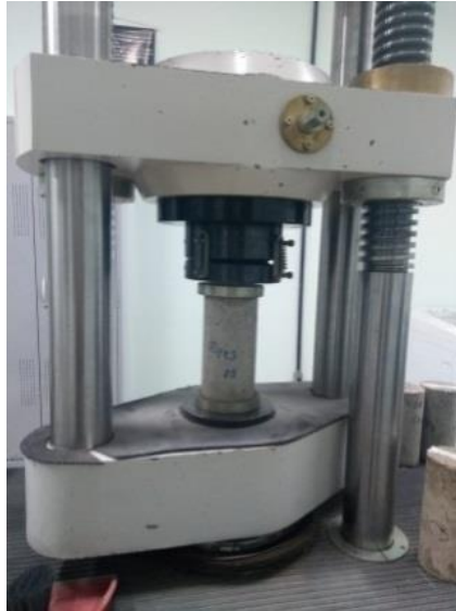
Figura 12 – Ensaio compressão axial
