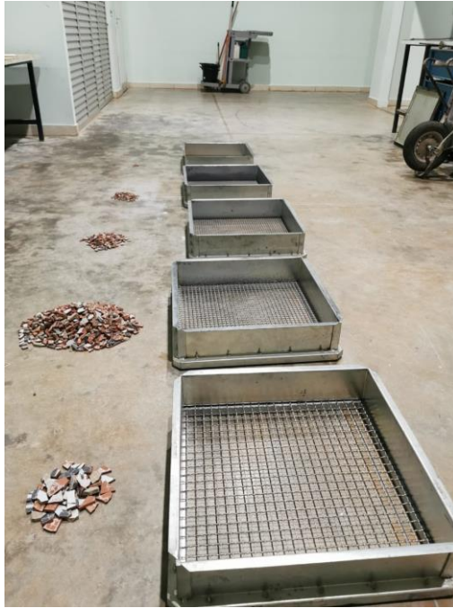
Figura 6 - Peneiramento utilizado para graduação do agregado reciclado de revestimento cerâmico
