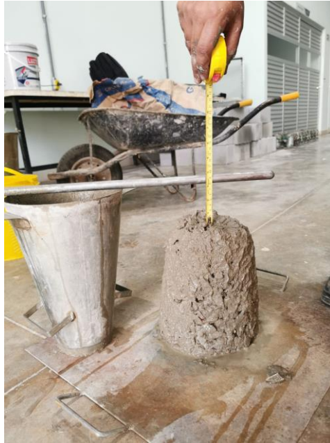
Figura 7 - Slump test realizado antes da moldagem dos corpos de prova
