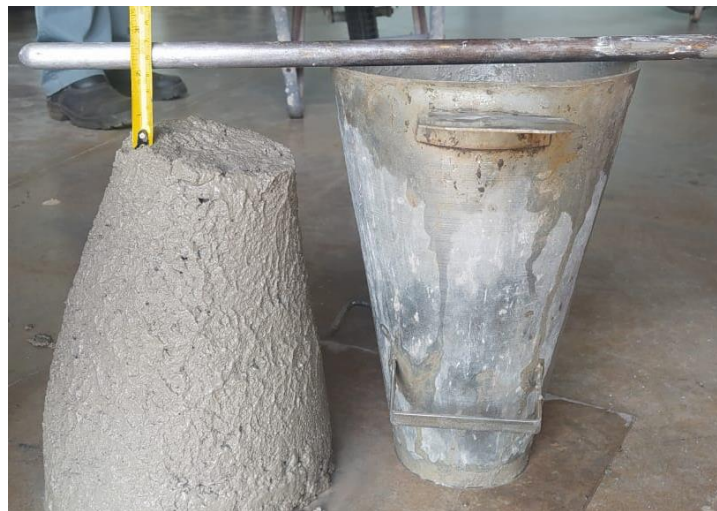
Figura 9 – Medição do abatimento obtido pelo Slump Test .
