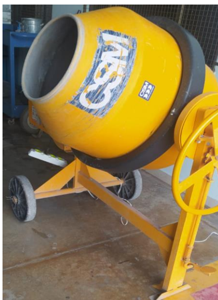
Figura 7 – Betoneira de 250 L utilizada no experimento.
