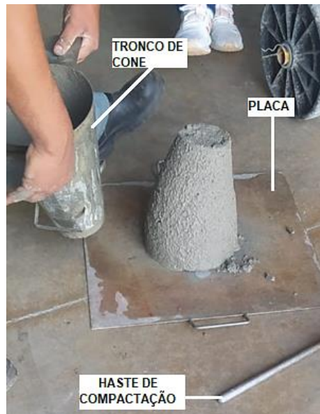
Figura 8 – Equipamentos utilizados para realização do Slump test .
