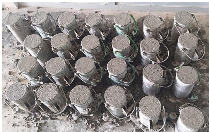
Figura 11 – Cura inicial dos corpos de prova.
