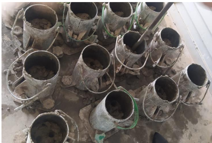
Figura 10 – Moldes cilíndricos utilizados para fabricação dos corpos de prova.
