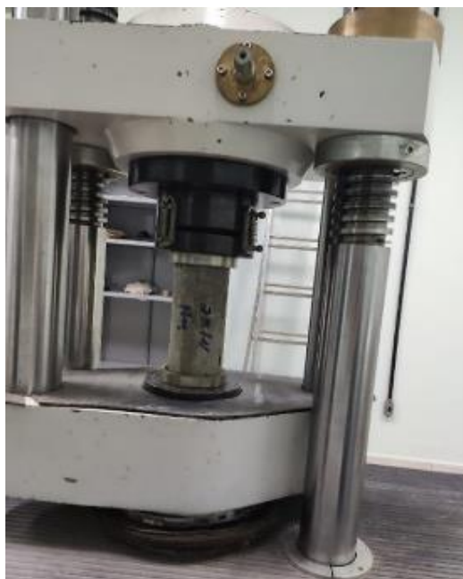
Figura 12 – Prensa com corpo de prova sendo preparado para o ensaio.
