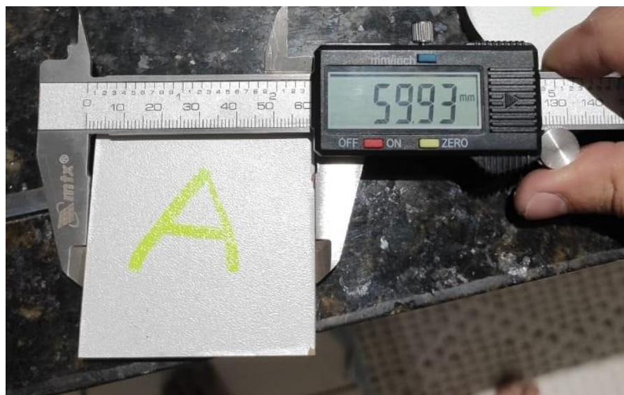
Figura 56 - Controle dimensional quadrado 60x60mm.
