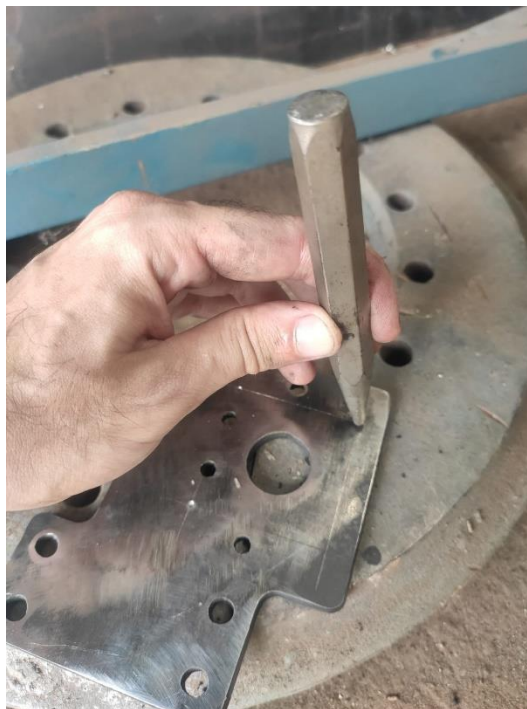
Figura 41 - Marcação do furo com punção.
