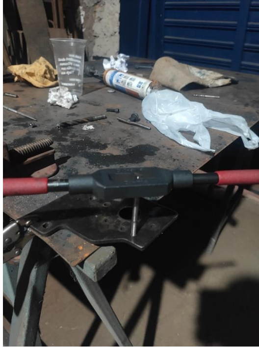
Figura 42 - Fabricação da rosca M5.
