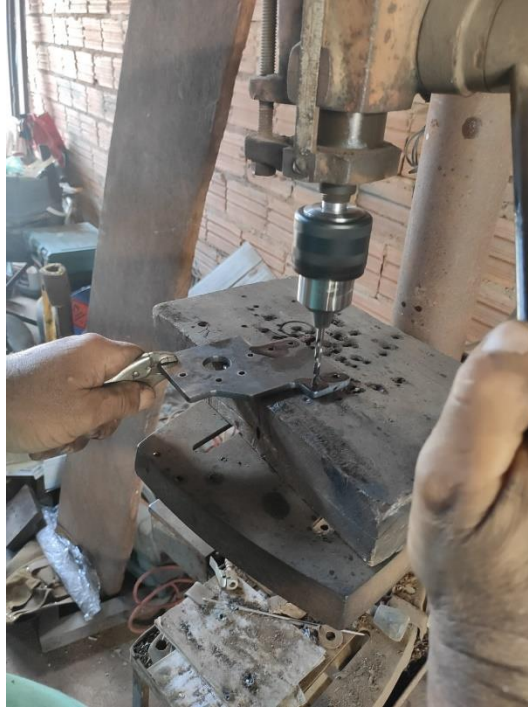
Figura 39 - Furos feitos na furadeira de bancada.
