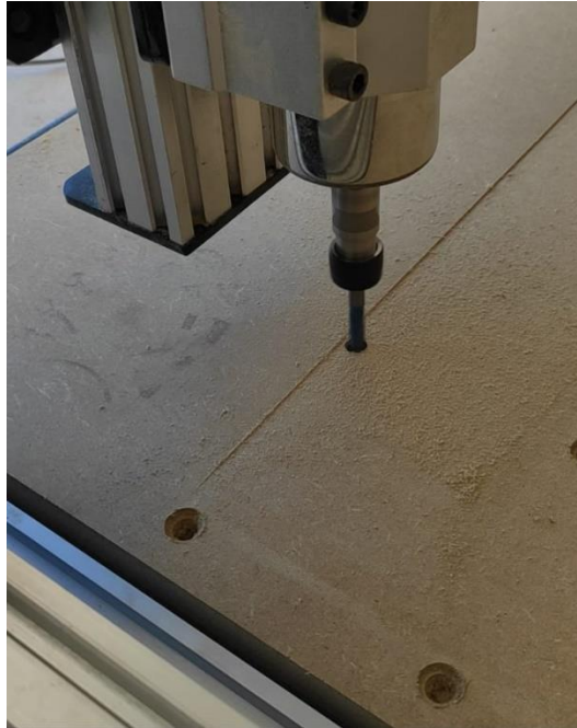
Figura 52 - Furação para fixação das buchas.
