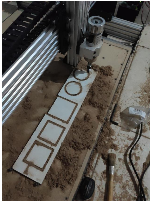
Figura 54 - Usinagem de corpos de teste.
