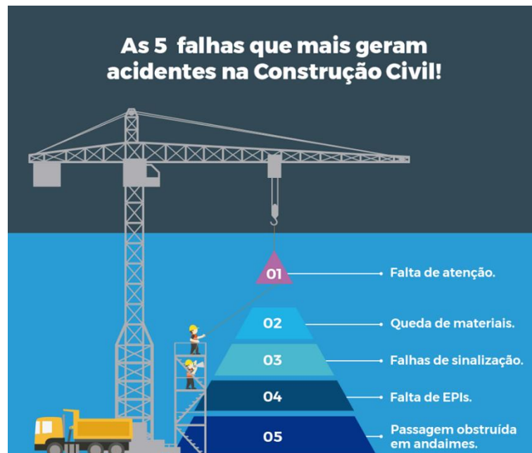
Figura 01- Principais falhas que acarretam acidentes em um canteiro de obras:
