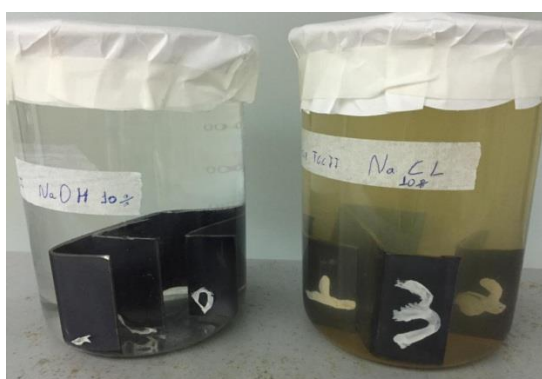
Figura 23 – experimento preliminar após 24 horas, início do processo de Corrosão em NaCl 10% p/v
