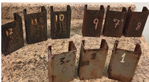
Figura 29 – Fotos dos corpos de prova do experimento principal (Semana 3)
