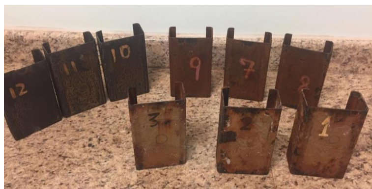
Figura 35 – Fotos dos corpos de prova do experimento principal (Semana 9)
