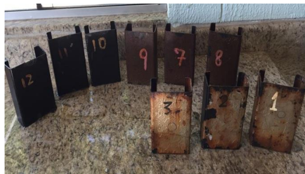
Figura 34 – Fotos dos corpos de prova do experimento principal (Semana 8)
