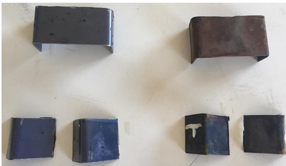
Figura 26 – Resultado final do experimento preliminar, do lado direito aparecem as peças mergulhadas em NaCl 10% p/v com processo corrosivo evidente
