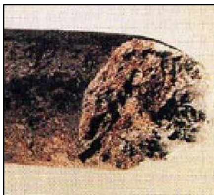
Figura 10 – Corrosão por tensão 10
