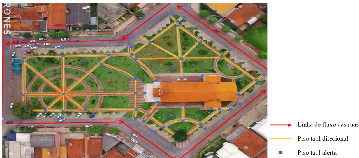
Figura 2. Diagrama de circulação e mapa tátil da Praça Jeribá em Rubiataba. Fonte: Adaptado de ElevDrones (2017).
