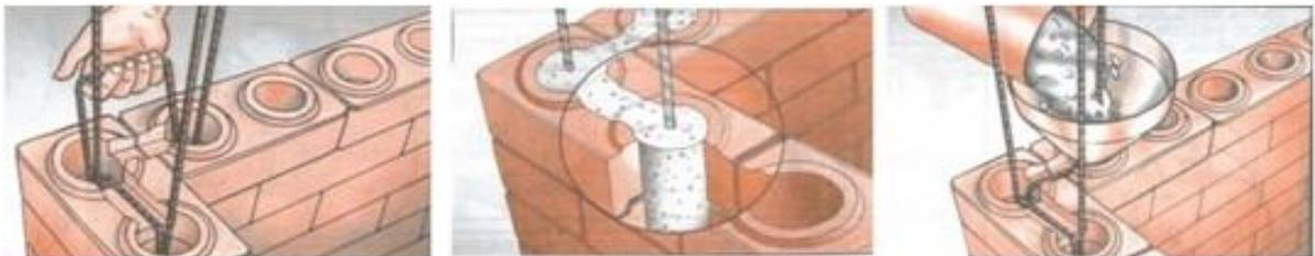
Figura 02 – Detalhe do preenchimento das colunas e das armações com os grampos.
