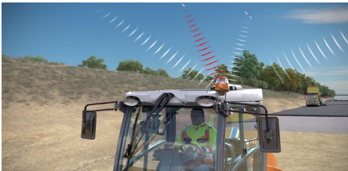
Figura 4: Receptores DGNSS para determinar a posição de cada rolo.
