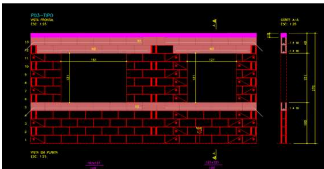
Figura 20: Vista frontal demonstrando em planta a construção da contra-verga, da verga e da última fiada grauteada e armada.
