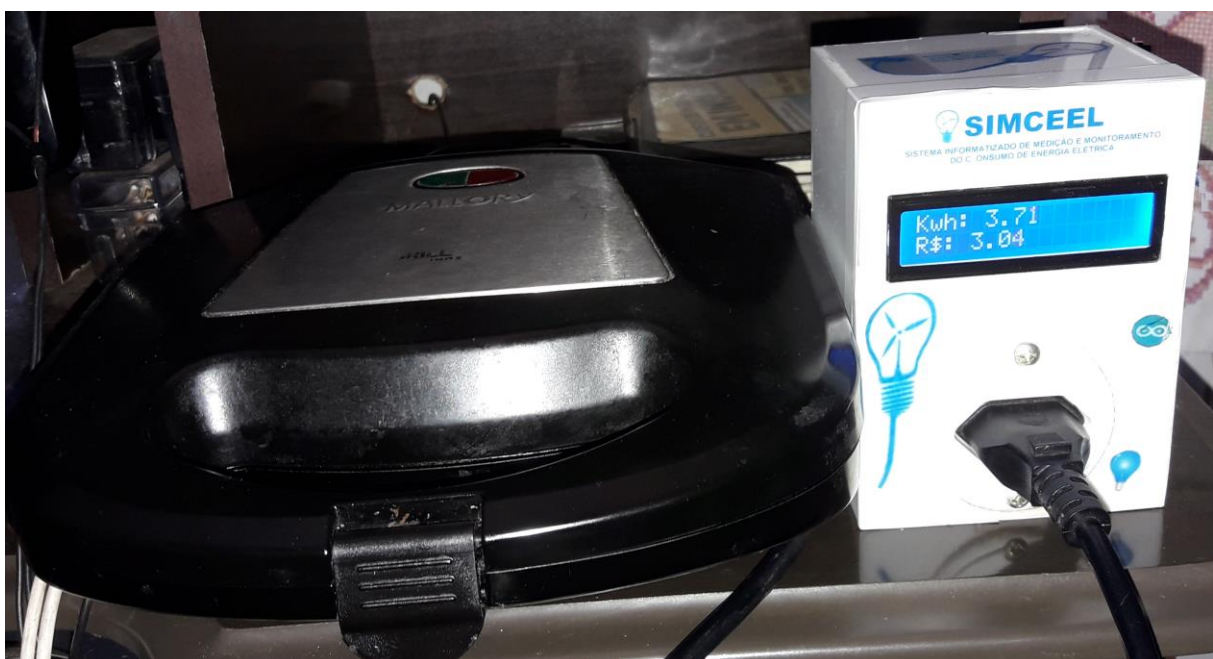
Figura 4.2 – Dispositivo SIMCEEL em teste com a Sanduicheira. Fonte: (O Autor, 2018)
