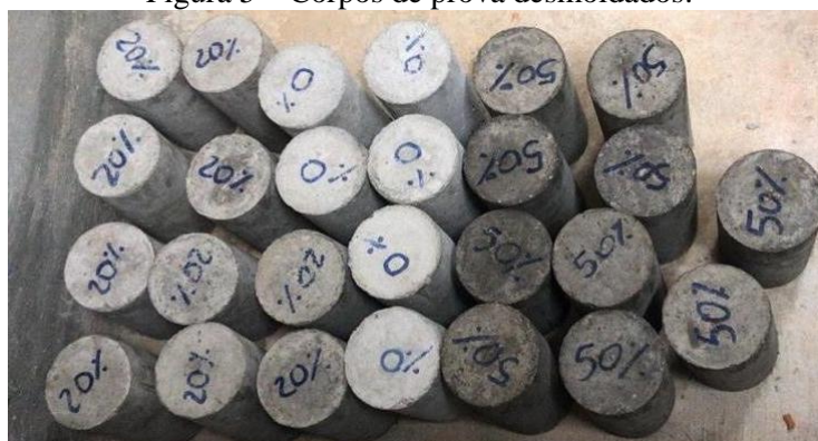
Figura 5 – Corpos de prova desmoldados.
