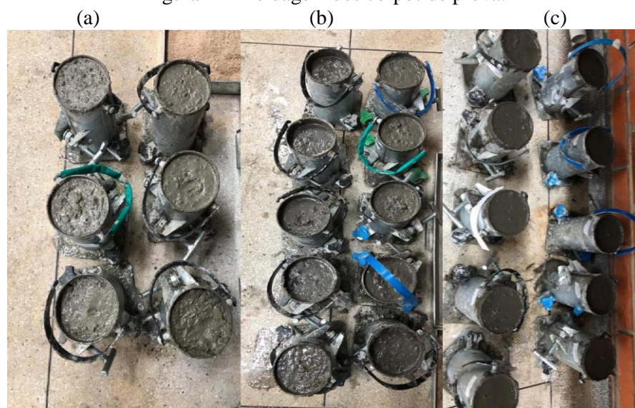
Figura 4 – Moldagem dos corpos de prova.
