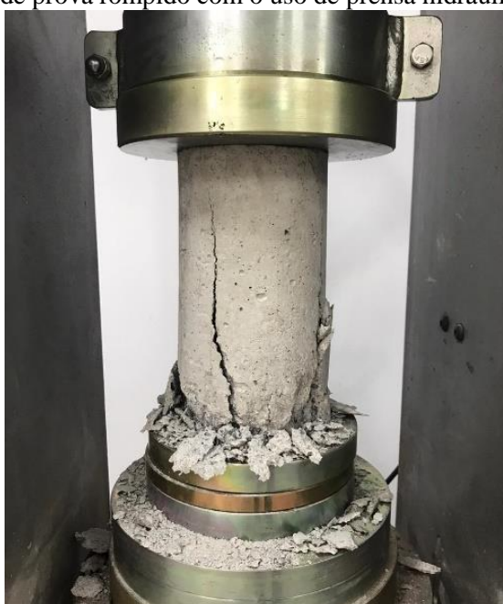
Figura 8 – Corpo de prova rompido com o uso de prensa hidráulica manual.
