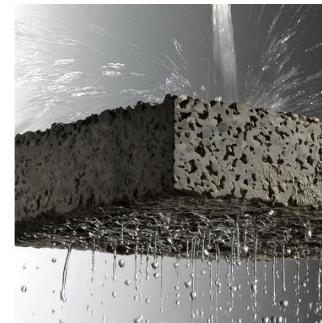
Pavimentação concreto Permeável cinza
