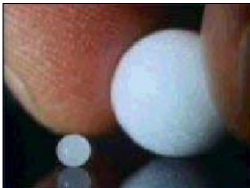
Figura 2 – Pérolas de PS após a pré-expansão e armazenamento intermediário.
