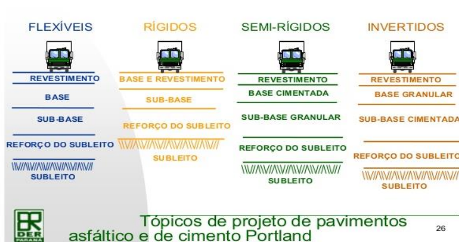
Figura 2 - Comparação entre os tipos de estrutura dos pavimentos
