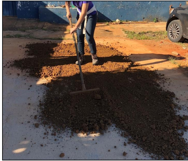
Figura 24: Secagem da Amostra.
